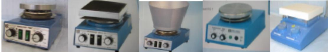
Diese Geräte wurden bis 1993 ohne zusätzlichen Sicherheitskreis nach VDE 0871 und IEC 1010 gebaut. Im Fehlerfall kann es zur Überhitzung des Mediums und der Heizplatte kommen.
